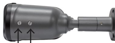
本体底面に、調整ネジがついておりますので、調整を行って下さい。
